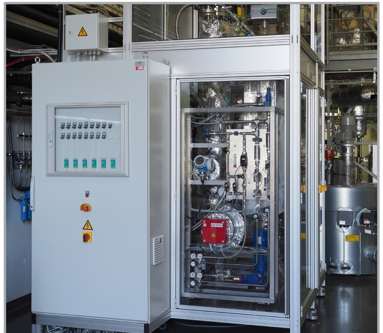
Plattenreaktor zur Methanisierung im Aufbau (oben) und als Modul für den Einsatz in der Tankstelle der Zukunft (unten) Quelle: ZSW
