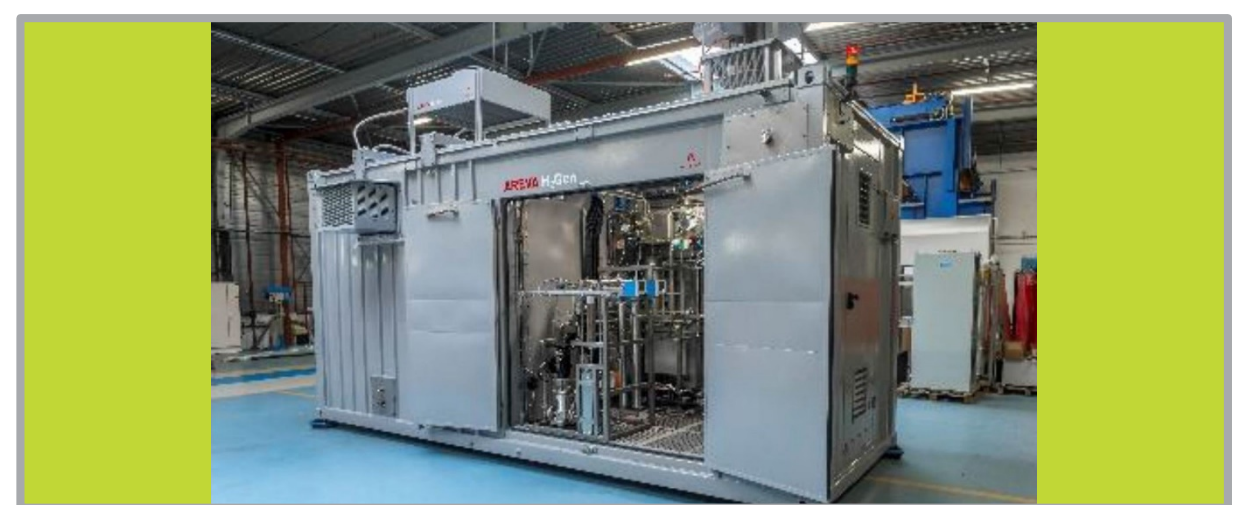
Abb. 2: PEM-Elektrolyse im Werk
